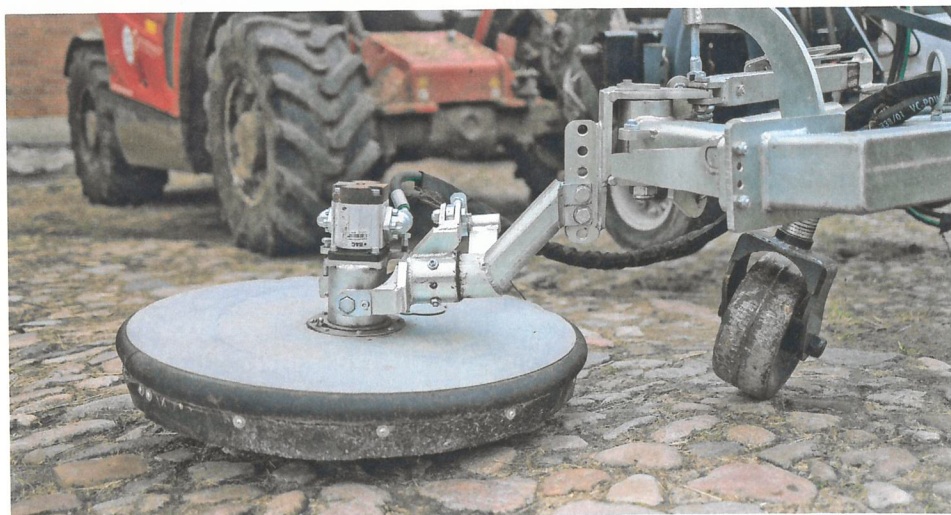
Regelmäßig muss der wolfsabweisende Zaun freigeschnitten werden, damit kein Strom durch Gräser und Sträucher abgeleitet wird. Dafür hat sich der Landwirt extra ein Mähwerk angeschafft.
